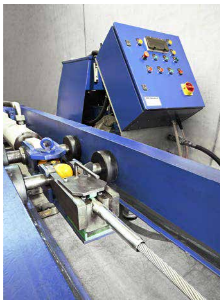
Kontrolliertes Ablängen und Vorrecken Découpes et pré-étirements contrôlés Controlled cutting to length and pre-stressing
